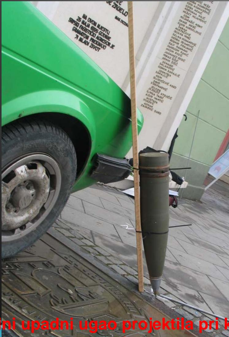
Minimalni upadni ugao projektila pri kojem će projektil mimoći bočnu stranu automobila „Golf“ je  $62^{\circ}$
